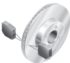
检测圆盘滑轮的厚度
