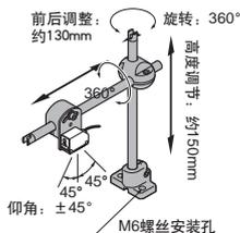
通过能够进行水平方向调整的曲臂,可从生产线上方进行检测。
